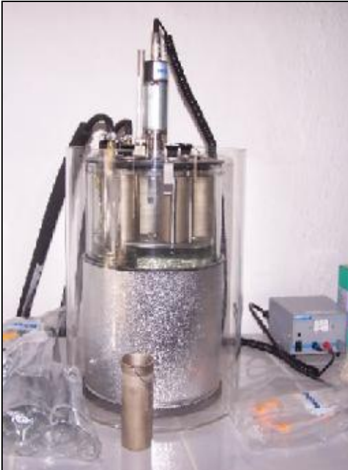
Şekil 4. Akma&Bulutlanma noktası tayin cihazı (Petrotest).
