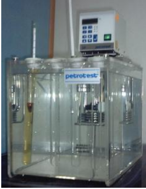
Şekil1. Yoğunluk ölçme cihazı (Petrotest)
